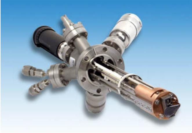
ミニチュアエバポレータ*e<sup>-</sup>-flux* は高真空超高真空環境下で高純度薄膜生成を行う為のソースユニットです。蒸着材料は電子衝撃加熱により蒸発し、フラックスは基板上に薄膜化堆積されます。磁場を使わない電子収束方式でロット状の材料を直に加熱蒸発させることが可能です。Crucibleを使用することでパウダー、フレーク又はチャンク状の材料蒸着にも対応可能です。高真空環境下でおこなう電子衝撃加熱蒸発は材料組成を変化させることなく、あらゆる高融点材料の薄膜化を可能にします。
