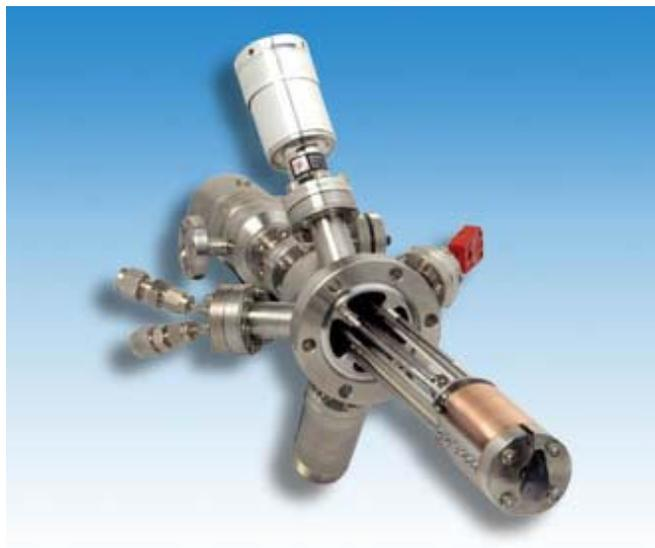
H-flux は水素 ( $H_2$ ) ガスを原料として解離水素を生成するサーマルクラッキングセルです。解離効率に優れ、イオン化成分を残さない高効率の水素専用クラッカーセルです。
